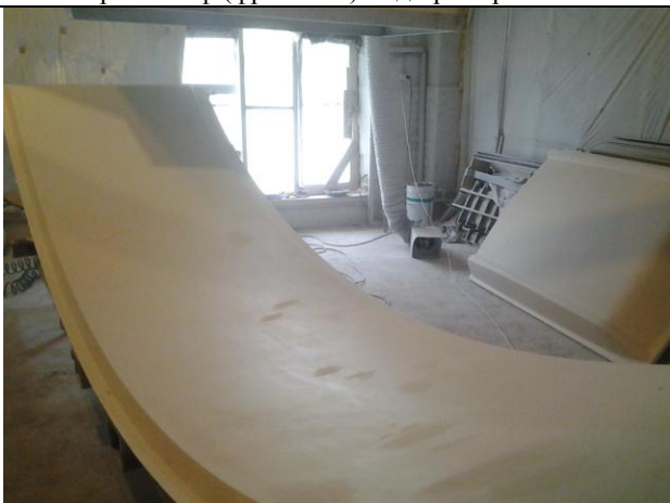
Элемент потолка над эскалатором московского метрополитена (Защитный зонд). Станция метро «Парк Культуры»
